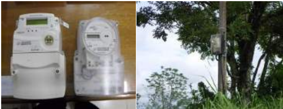
Figura 6 - Medidores com sistema PLC
